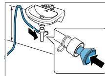
Зафіксуйте точку підключення за допомогою затискача шланга (12-22 мм). Закріпіть зливний шланг за допомогою направляючої для шланга на
